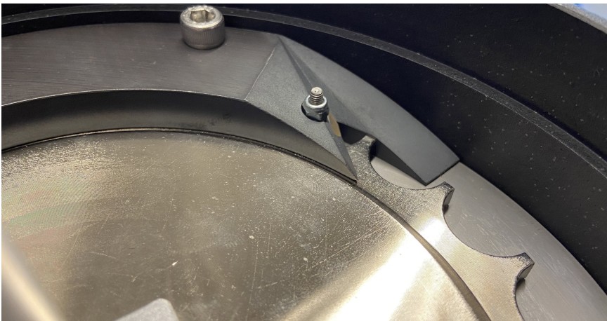
Dosierscheibenprinzip: Das Abstreifen der Taschen mit dem Schermesser sorgt für eine gleichmäßige Materialabmessung und Dosierung © Plastrac
